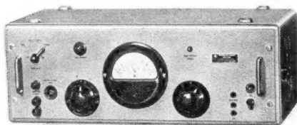
Bild 3. Direkt zeigendes Klirrfaktormessgerät für 4 Meßfrequenzen (Typ FTZ)
