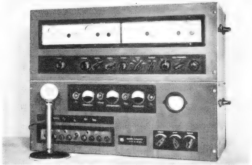
Gesamtansicht des betriebsfertigen Amateur-KW-Senders. Unten befinden sich Netzteil und Oszilloskop, während im oberen Teil der eigentliche Sender untergebracht ist
